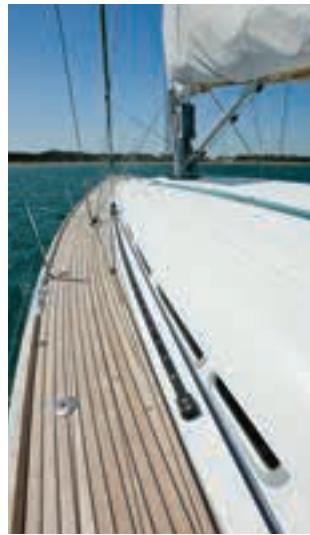
Panneaux de pont « flush », écoutes et drisses encastrées, main-courante en prise sous les paupières de hublots, larges passavants... : le pont prend le parti d'une circulation fluide et parfaitement sécurisée.
